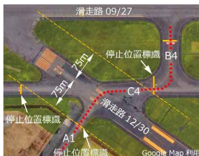
誘導路C4-A1経由部分の停止位置標識 （赤の点線は想定される走行経路）
